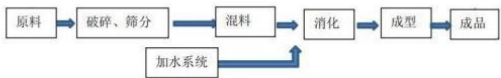
图3-4 复合型氢氧化钙生产工艺流程图
